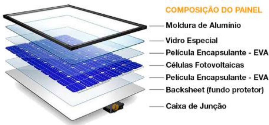
FIGURA 6 – ESTRUTURA DO PAINEL FOTOVOLTAICO
