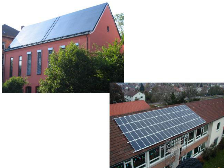
Figura 10: Exemplo de módulos solares fotovoltaicos de CIGS em substrato de vidro para aplicações arquitetônicas [Würth Solar GmbH].
